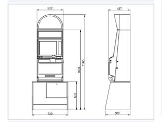
高さ(HEIGHT):1965mm 幅 (WIDTH):720mm 奥行 (DEPTH):500mm 重量(WEIGHT):120Kg 消費電力 (POWER): 110Wh AC100V 50/60Hz
